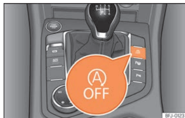
Fig. 167 Console centrale : touche du système Start-Stop.
