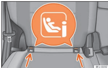
Fig. 26 Sièges latéraux de la seconde rangée : anneaux de fixation ISOFIX/i-Size.
