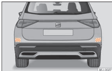
Fig. 178 Vue arrière du véhicule : zones des capteurs radars.
