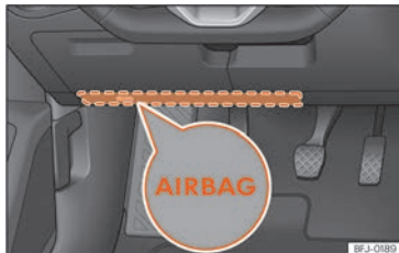
Fig. 19 Côté conducteur : emplacement de l'airbag de genoux.
