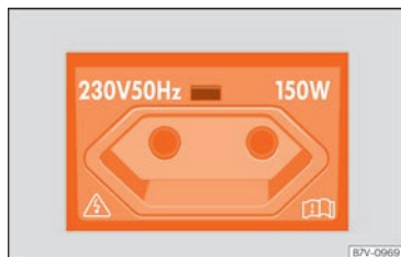
Fig. 146 Sur le côté gauche du coffre à bagages : prise de courant de 230 volts.
