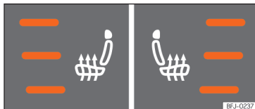
Fig. 150 Sur la console centrale : commandes du chauffage des sièges avant.
