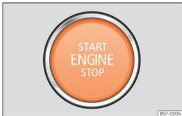
Fig. 164 Sur la partie inférieure de la console centrale : touche de démarrage.
