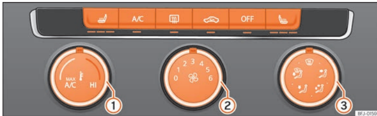
Fig. 148 Sur la console centrale : commandes du climatiseur manuel.
