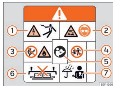
Fig. 224 Étiquette d'avertissement sur la batterie à haute tension.
