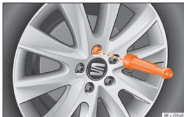
Fig. 39 Changement de roue : dévisser les boulons de roue avec le manche du tournevis.
