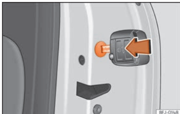
Fig. 82 Verrouillage d'urgence de la porte.
