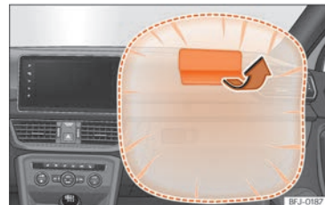
Fig. 16 Airbag du passager avant sur le combiné d'instruments.
