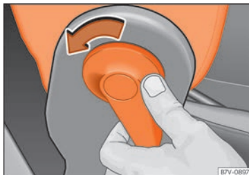
Fig. 114 Débloquer le dossier rabattable du siège du passager.
