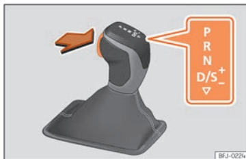
Fig. 169 Verrouillage du levier sélecteur.
