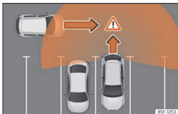
Fig. 199 Représentation schématique de l'assistant de sortie de stationnement : zone surveillée autour du véhicule sortant de stationnement.
