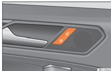
Fig. 77 Porte du conducteur : commande de verrouillage centralisé.
