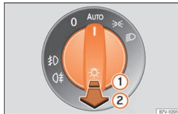
Fig. 79 Tableau de bord : commande des feux.
