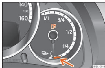
Fig. 149 Sur le tableau de bord : indicateur de l'état de charge de la batterie à haute tension avec la zone de réserve indiquée en rouge (flèche).
