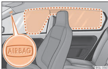
Fig. 19 Emplacement et zone de déploiement de l'airbag rideau.
