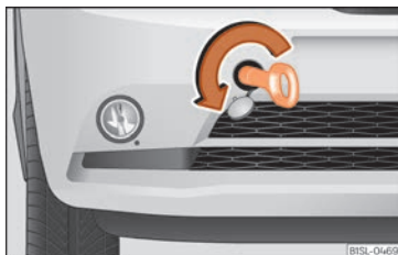
Fig. 43 Partie droite du pare-chocs avant : œillet de remorquage vissé.
