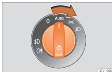
Fig. 78 Tableau de bord : commande des feux.
