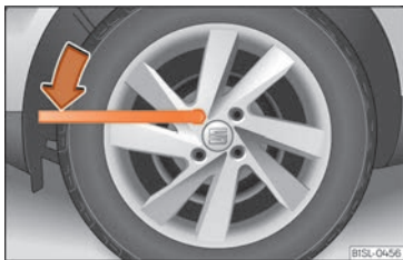
Fig. 33 Changement de roue : desserrer les boulons de la roue
