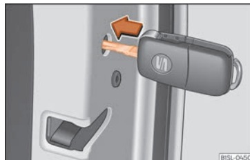
Fig. 71 Verrouillage de secours du véhicule avec la clé de celui-ci.
