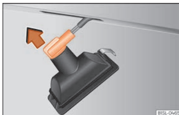
Fig. 55 Éclairage de la plaque d'immatriculation : démontage du porte-ampoules.
