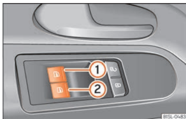
Fig. 76 Détail de la portière du conducteur : commandes des vitres.
