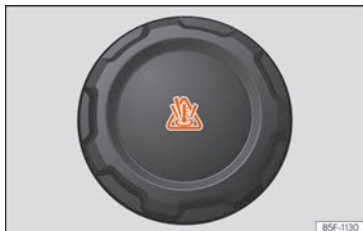
Fig. 234 Compartiment-moteur : bouchon du vase d'expansion du liquide de refroidissement.
