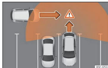
Fig. 193 Représentation schématique de l'assistant de sortie de stationnement : zone surveillée autour du véhicule sortant de stationnement.
