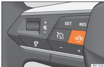
Fig. 73 Partie gauche du volant multifonction : touche pour les systèmes d'assistance à la conduite (en fonction des versions).
