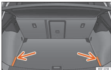
Fig. 124 Dans le coffre à bagages : caches de rangement de la plage arrière.
