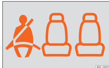
Fig. 10 Combiné d'instruments : indication de place arrière gauche occupée et de ceinture correspondante bouclée.
