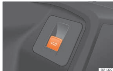
Fig. 95 Sur la porte du conducteur : touche d'ouverture et de fermeture du hayon arrière.
