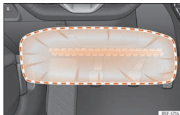
Fig. 23 Côté conducteur : rayon d'action de l'airbag de genoux.
