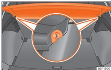
Fig. 123 Dans le coffre à bagages : dépose et repose de la plage arrière.
