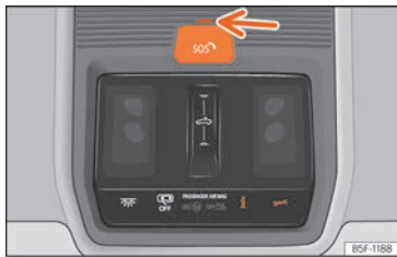
Fig. 37 Sur la console de pavillon : commande pour les services vocaux
