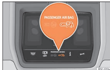
Fig. 21 Sur la console de pavillon : témoin de contrôle de la désactivation de l'airbag du passager avant.
