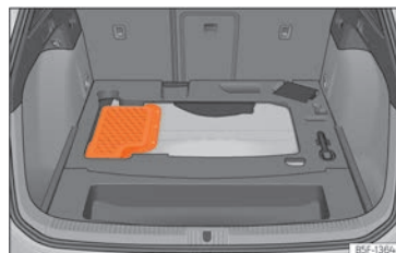
Fig. 237 Véhicules hybrides (PHEV) : emplacement de la batterie dans le coffre à bagages
