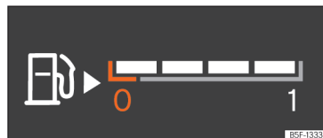
Fig. 68 Combiné d'instruments numérique : indicateur de niveau de carburant détecté dans différentes positions en fonction de la vue.
