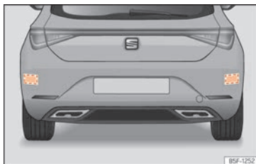
Fig. 172 Vue arrière du véhicule : zones des capteurs radars.
