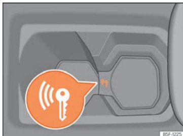
Fig. 148 Sur la console centrale : démarrage d'urgence.
