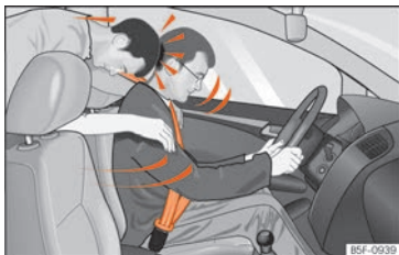
Fig. 10 L'occupant de la banquette arrière non attaché est projeté en avant et vient heurter le conducteur attaché.
