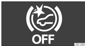
Fig. 160 Sur l'écran du tableau de bord : indication de Front Assist désactivé.
