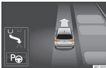
Fig. 184 Sur l'écran du tableau de bord : affichage du système de stationnement assisté avec affichage réduit.
