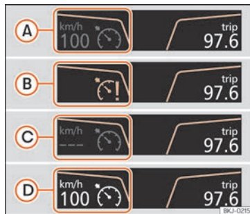
Fig. 154 Afficheur du combiné d'instruments : indications d'état du GRA.
