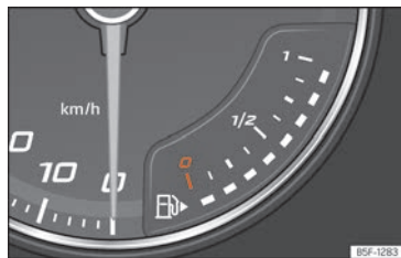
Fig. 58 Tableau de bord analogique : indicateur de niveau de carburant
