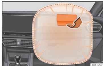
Fig. 16 Airbag du passager dans le combiné d'instruments.
