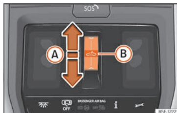
Fig. 88 Dans le ciel de pavillon : touche du toit ouvrant.
