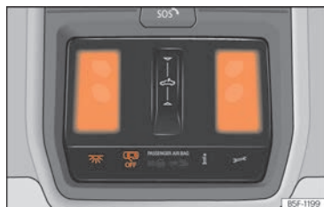
Fig. 93 Détail du ciel de pavillon : plafonnier avant.
