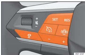
Fig. 165 Sur le volant multifonction : touches de manipulation de l'ACC
