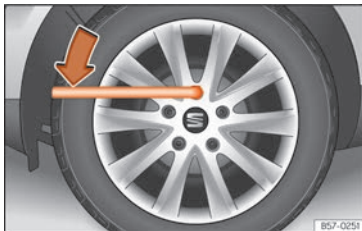
Fig. 38 Changement de roue : desserrer les vis de roue.
