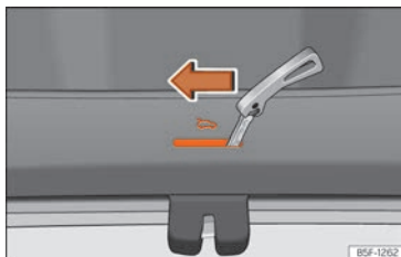
Fig. 85 Détail du coffre à bagages : déverrouillage d'urgence (Leon).
