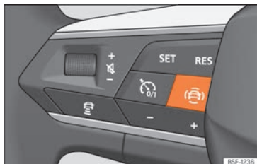
Fig. 64 Partie gauche du volant multifonction : clé pour les systèmes d'assistance à la conduite [en fonction des versions].
