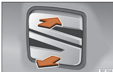
Fig. 81 Hayon : ouverture de l'extérieur.
