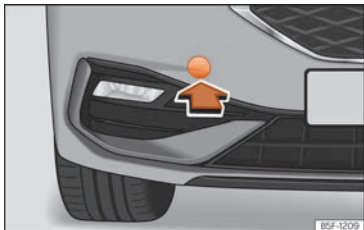
Fig. 46 Du côté droit du pare-chocs avant : retirer le cache.
