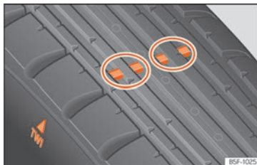
Fig. 210 Sculptures du pneu : indicateurs d'usure.
