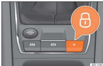
Fig. 75 Sur la console centrale : commande du verrouillage centralisé
