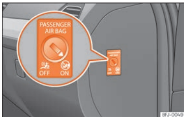
Fig. 17 Commande à clé permettant d'activer et de désactiver les airbags du passager.
