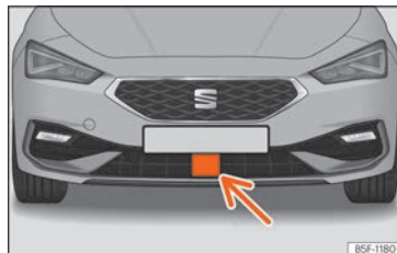
Fig. 161 Au niveau du pare-chocs avant : capteur radar.
