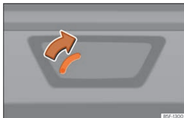
Fig. 86 Détail du coffre à bagages : déverrouillage d'urgence (Leon Sportstourer).
