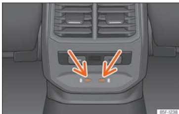
Fig. 146 Partie arrière de la console centrale : connecteurs USB avec fonction de prise de courant.
