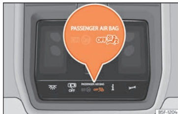
Fig. 18 Sur la console de pavillon : témoin de désactivation de l'airbag du passager avant.
