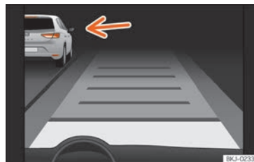
Fig. 166 Sur l'écran du tableau de bord : ACC activé, véhicule circulant à gauche détecté
