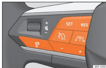
Fig. 173 Partie gauche du volant multifonction : touches pour utiliser Travel Assist.
