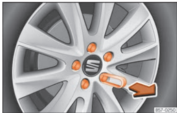
Fig. 36 Roue : boulons de roue avec capuchons.
