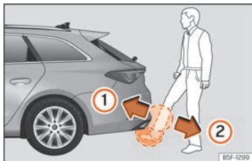
Fig. 84 Hayon du coffre à bagages à ouverture contrôlée par capteur (Easy Open).
