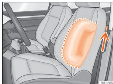
Fig. 21 Airbag latéral dans le siège du conducteur.
