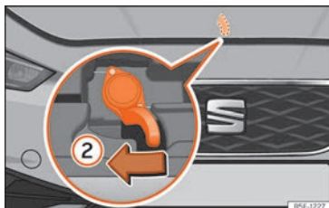
Fig. 200 Levier sous le capot.
