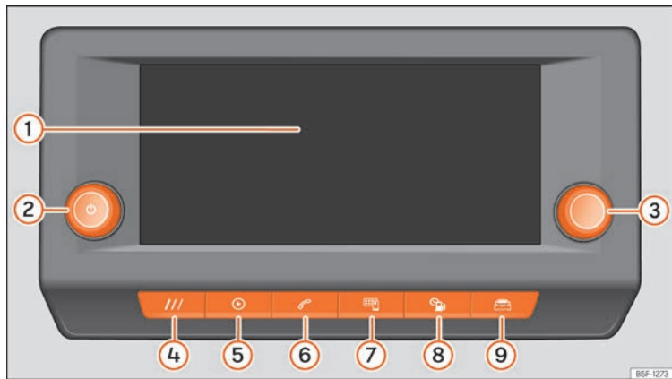
Fig.139 Synoptique : unité de commandes et indication dans la version de 8,25 pouces
