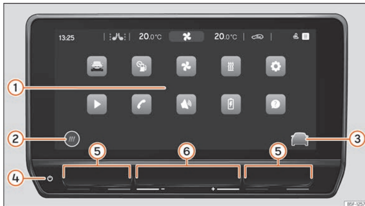
Fig.138 Synoptique : unité de commandes et d'indication dans la version de 10 pouces
