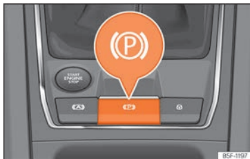
Fig. 182 Sur la partie inférieure de la console centrale : touche du frein de stationnement électronique.
