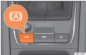
Fig. 183 Sur la partie inférieure de la console centrale : touche de fonction Auto Hold.
