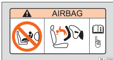
Fig. 25 Autocollant de l'airbag : sur le pare-soleil du côté passager
