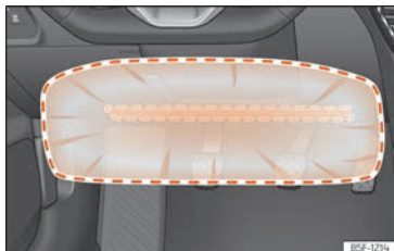
Fig. 20 Côté conducteur : rayon d'action de l'airbag de genoux.
