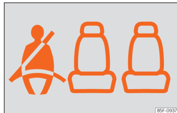
Fig. 7 Combiné d'instruments : indication de place arrière gauche occupée et de ceinture correspondante bouclée.
