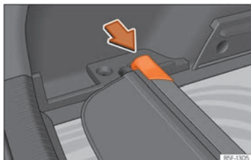
Fig. 115 Dans le coffre à bagages : logement de rangement de la plage arrière.
