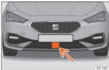
Fig. 164 Au niveau du pare-chocs avant : capteur radar.
