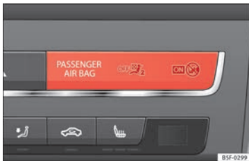
Fig. 53 Témoignage de désactivation de l'airbag du passager.
