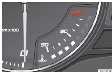
Fig. 124 Combiné d'instruments : indicateur de température du liquide de refroidissement
