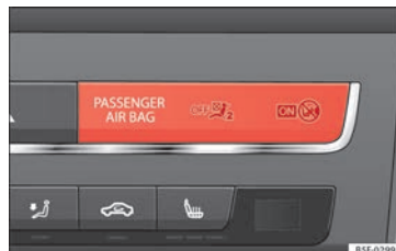
Fig. 23 Planche de bord : témoin de désactivation de l'airbag du passager avant.
