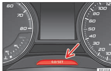
Fig. 123 Combiné d'instruments : compteur kilométrique et touche de remise à zéro.
