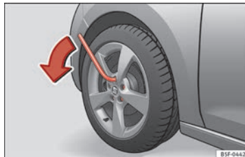
Fig. 74 Roue : desserrer les vis de roue.
