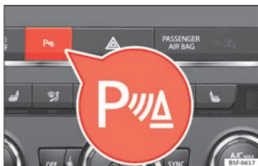
Fig. 226 Console centrale : touche de l'aide au stationnement.
