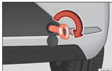
Fig. 100 Pare-chocs arrière droit : œillet de remorquage vissé
