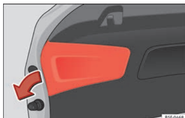
Fig. 116 Retirer le cache du hayon arrière
