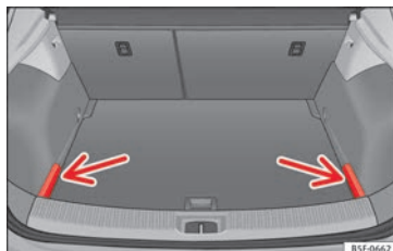
Fig. 167 Dans le coffre à bagages : caches pour ranger la plage arrière.
