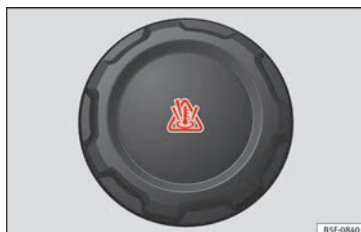
Fig. 63 Compartiment-moteur : bouchon du vase d'expansion du liquide de refroidissement.
