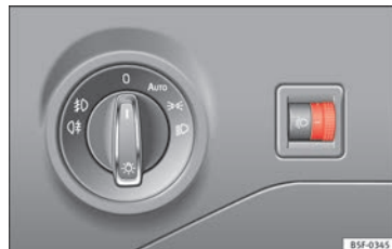
Fig. 144 Côté volant : dispositif de réglage de la portée des phares.
