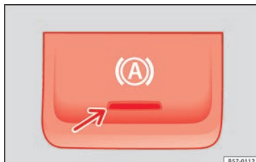
Fig. 202 Sur la partie inférieure de la console centrale : bouton de fonction Auto Hold.
