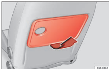
Fig. 158 Siège avant gauche : tablette escamotable.
