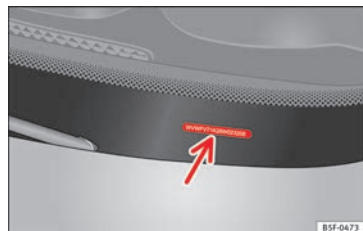
Fig. 258 Numéro de châssis.
