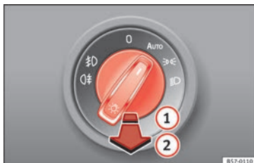
Fig. 142 Planche de bord : commande des feux.
