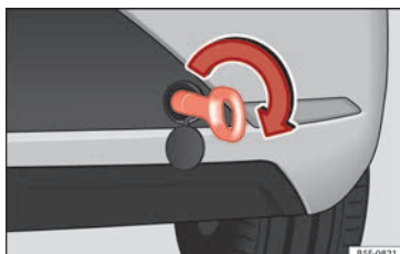
Fig. 78 Pare-chocs arrière droit : œillet de remorquage vissé
