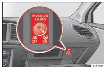
Fig. 95 Commande à clé permettant d'activer et de désactiver les airbags du passager avant.
