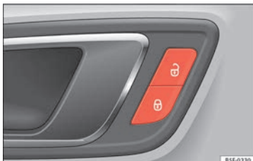
Fig. 2 Porte du conducteur : commande de verrouillage centralisé.
