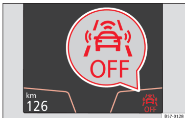
Fig. 206 Sur l'écran du combiné d'instruments : indication de Front Assist désactivé.
