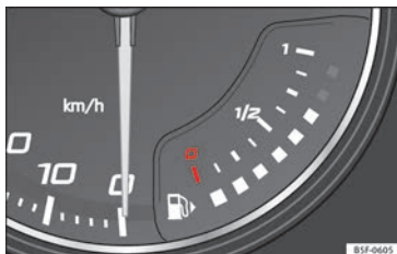
Fig. 125 Combiné d'instruments : indicateur de niveau d'essence/diesel
