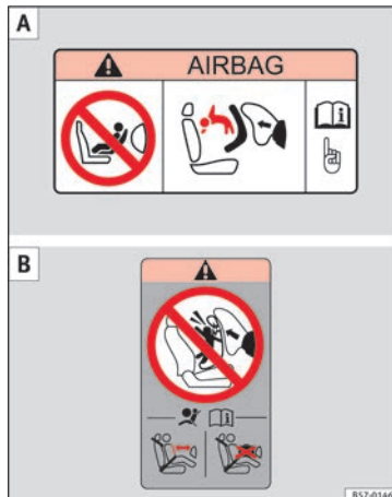
Fig. 30 Autocollant de l'airbag - version 2 : sur le pare-soleil côté passager A et sur le cadre arrière de la porte du passager B .
