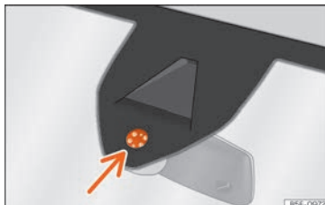
Fig. 103 Surface sensible du détecteur de pluie.
