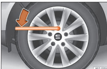
Fig. 36 Changement de roue : desserrer les vis de roue.
