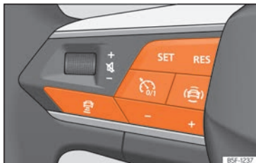
Fig. 152 Sur le volant multifonction : boutons de commande de l'ACC.
