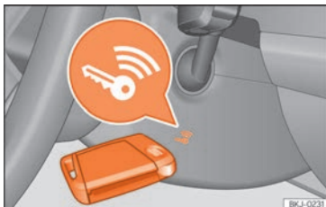
Fig. 134 À droite de la colonne de direction : démarrage d'urgence.
