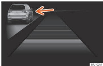
Fig. 154 Sur l'écran du combiné d'instruments : ACC activé, véhicule circulant à gauche détecté.
