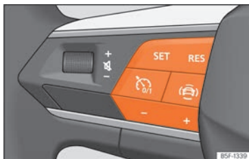
Fig. 148 Sur le volant multifonction : boutons permettant d'actionner le régulateur de vitesse.
