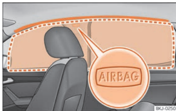
Fig. 20 Emplacement et zone de déploiement de l'airbag rideau.
