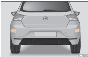
Fig. 145 Vue arrière du véhicule : zones des capteurs radars.
