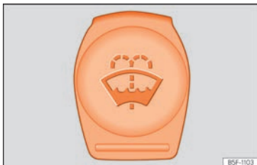
Fig. 194 Dans le compartiment moteur : bouchon bleu du réservoir de liquide lave-glace.
