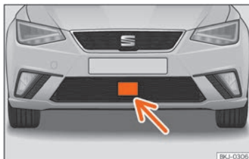
Fig. 142 Au niveau du pare-chocs avant : capteur radar.
