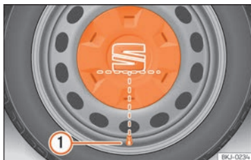
Fig. 32 Placement correct de l'enjoliveur central de roues pour jantes en acier.
