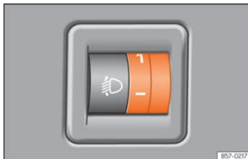
Fig. 99 Côté volant : dispositif de réglage de la portée des phares.
