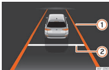
Fig. 158 Sur l'écran du combiné d'instruments : indication avec régulation activée.
