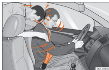
Fig. 9 L'occupant de la banquette arrière non attaché est projeté en avant et vient heurter le conducteur attaché.
