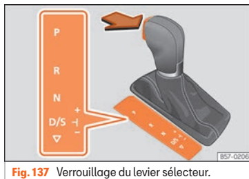
Fig. 137 Verrouillage du levier sélecteur.
