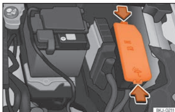
Fig. 50 Dans le compartiment moteur : couvercle de boîte à fusibles.
