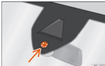
Fig. 106 Surface sensible du détecteur de pluie.
