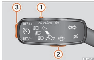
Fig. 153 Sur le levier des clignotants : des touches permettent d'actionner le limiteur de vitesse.
