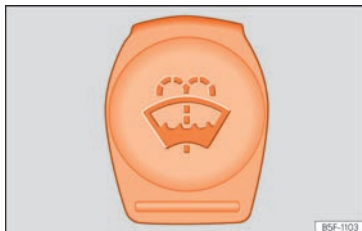
Fig. 191 Dans le compartiment-moteur : bouchon du réservoir de liquide lave-glace.
