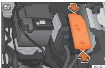
Fig. 50 Dans le compartiment-moteur : cache du boîtier de fusibles.
