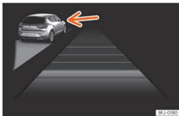
Fig. 160 Sur l'écran du combiné d'instruments : ACC activé, véhicule circulant à gauche détecté
