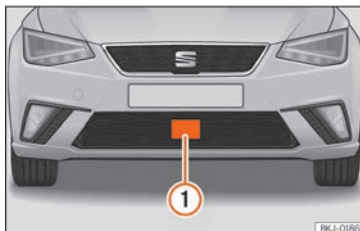
Fig. 146 Au niveau du pare-chocs avant : capteur radar.
