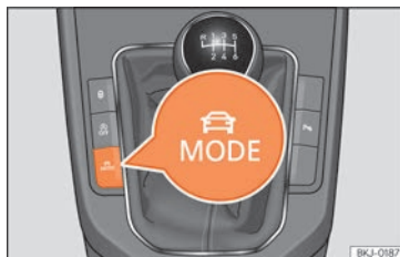
Fig. 145 À côté du levier de vitesses : touche MODE .
