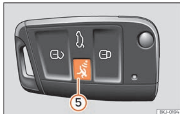
Fig. 82 Clé du véhicule avec bouton d'alarme.
