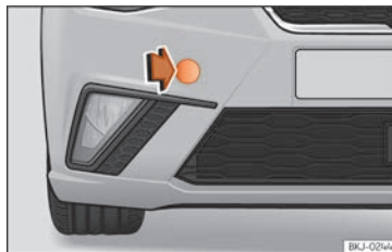
Fig. 45 Pare-chocs avant droit : retirer le cache.
