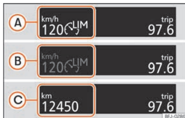
Fig. 152 Sur l'écran du combiné d'instruments : indications de l'état du limiteur de vitesse.
