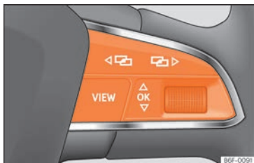
Fig. 73 Partie droite du volant multifonction : touches permettant d'utiliser les menus et les messages d'information du combiné d'instruments.
