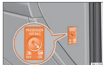
Fig. 16 Commande à clé permettant d'activer et de désactiver les airbags du passager avant.
