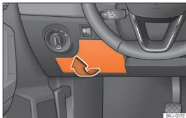
Fig. 49 Sur le tableau de bord côté conducteur : cache du boîtier de fusibles.
