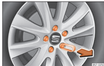
Fig. 34 Roue : boulons de roue avec capuchons.
