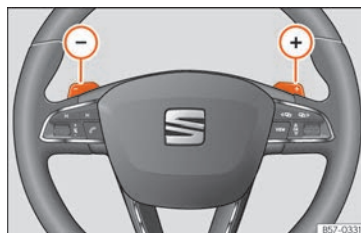
Fig.143 Volant : palettes pour boîte automatique.
