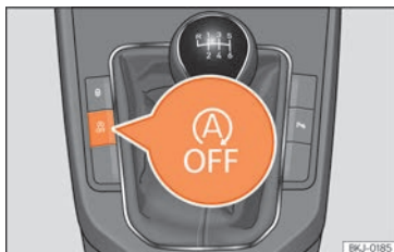
Fig. 139 Console centrale : touche du système Start-Stop.
