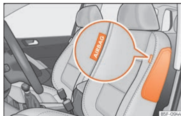
Fig. 18 Airbag latéral dans le siège du conducteur.
