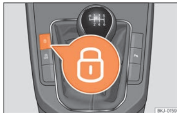
Fig. 86 Console centrale : touche de verrouillage centralisé.
