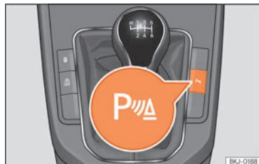
Fig. 165 Console centrale : touche de l'aide au stationnement (en fonction des versions).
