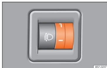
Fig. 102 Côté volant : dispositif de réglage de la portée des phares.
