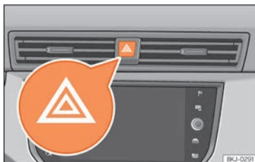
Fig. 101 Planche de bord : commande des feux de détresse.
