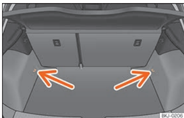
Fig. 120 Emplacements des œillets d'arrimage dans le coffre à bagages.
