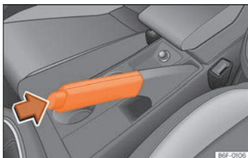
Fig. 163 Frein à main entre les sièges avant.
