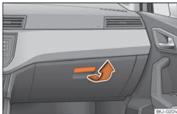
Fig. 122 Côté passager avant : boîte à gants.
