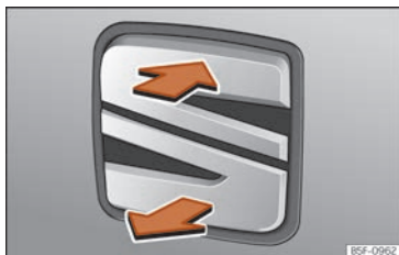
Fig. 93 Hayon : ouverture de l'extérieur.
