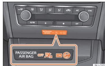
Fig. 17 Au centre du combiné d'instruments : témoin de contrôle de la désactivation de l'airbag du passager avant.
