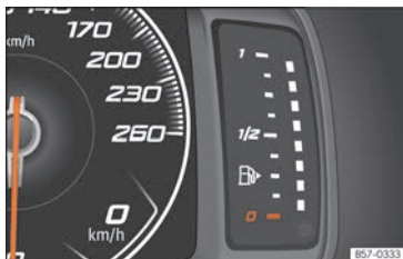
Fig. 69 Combiné d'instruments numérique : indicateur du niveau de carburant.
