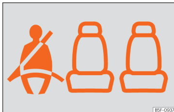
Fig. 6 Combiné d'instruments : indication de place arrière gauche occupée et de ceinture correspondante bouclée.
