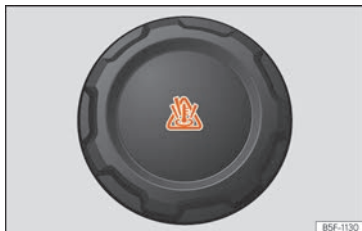
Fig. 189 Compartiment-moteur : bouchon du vase d'expansion du liquide de refroidissement.
