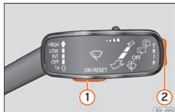
Fig. 74 Levier d'essuie-glace : touches de contrôle.
