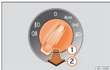
Fig. 99 Planche de bord : commande des feux.
