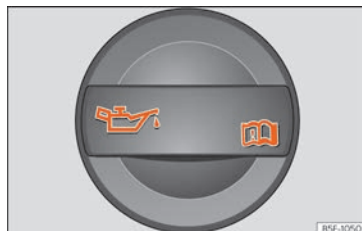
Fig. 187 Dans le compartiment-moteur : bouchon de l'orifice de remplissage d'huile moteur.
