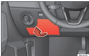
Fig. 71 Sur le tableau de bord côté conducteur : cache du boîtier de fusibles.
