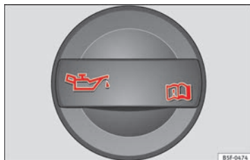
Fig. 67 Dans le compartiment-moteur : bouchon de l'orifice de remplissage d'huile moteur.
