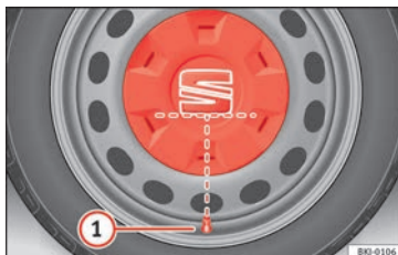
Fig. 78 Placement correct de l'enjoliveur central de roues pour jantes en acier.
