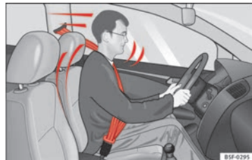
Fig. 100 Les conducteurs qui ont correctement bouclé leur ceinture de sécurité ne seront pas projetés en cas de freinage soudain.
