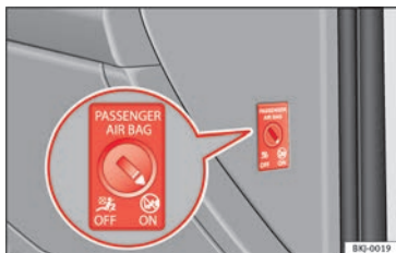
Fig. 105 Commande à clé permettant d'activer et de désactiver les airbags du passager avant.
