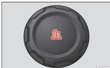
Fig. 68 Compartiment-moteur : bouchon du vase d'expansion du liquide de refroidissement.
