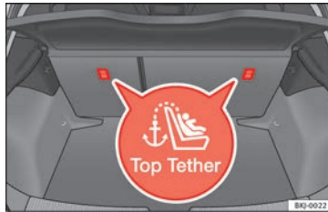
Fig. 33 Position des anneaux Top Tether sur la partie arrière de la banquette arrière.
