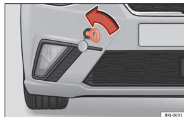
Fig. 87 Pare-chocs avant droit : œillet de remorquage.
