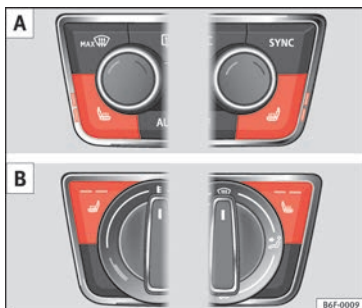
Fig. 156 Dans la console centrale : commandes du chauffage des sièges avant. A : version avec Climatronic. B : version avec climatiseur manuel.
