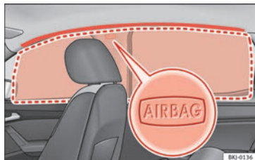
Fig. 27 Emplacement et zone de déploiement de l'airbag rideau.
