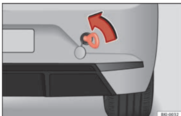
Fig. 111 Pare-chocs arrière droit : œillet de remorquage vissé
