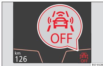
Fig. 193 Sur l'écran du combiné d'instruments : indication de Front Assist désactivé.
