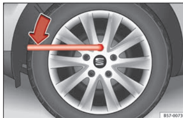
Fig. 83 Changement de roue : desserrer les vis de roue.
