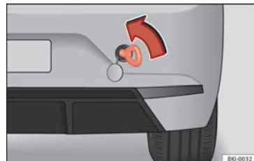
Fig. 88 Pare-chocs arrière droit : œillet de remorquage.
