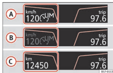
Fig. 188 Sur l'écran du combiné d'instruments : indications de l'état du limiteur de vitesse.
