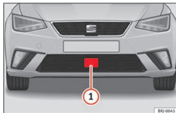
Fig. 192 Au niveau du pare-chocs avant : capteur radar.
