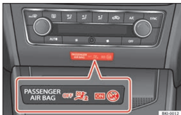
Fig. 106 Sur le tableau de bord, au centre : témoin de désactivation de l'airbag du passager avant.
