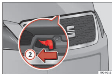
Fig. 10 Levier sous le capot.
