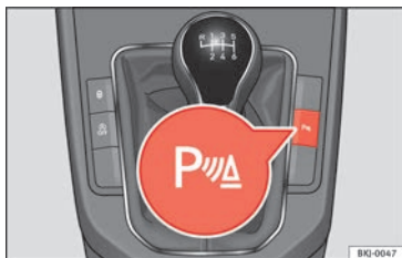
Fig. 207 Console centrale : touche de l'aide au stationnement.
