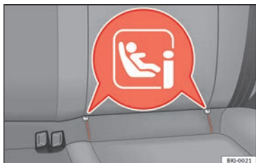
Fig. 34 Anneaux de fixation ISOFIX/iSize.
