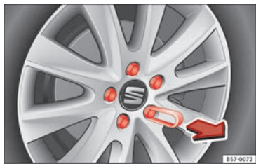
Fig. 82 Roue : boulons de roue avec capuchons.
