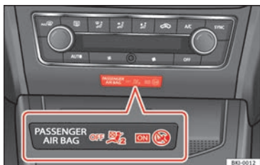
Fig. 24 Sur le tableau de bord, au centre : témoin de désactivation de l'airbag du passager avant.
