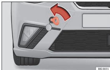
Fig. 109 Pare-chocs avant droit : œillet de remorquage vissé
