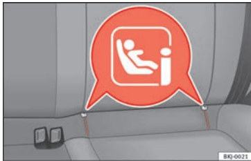
Fig. 32 Anneaux de fixation ISOFIX/iSize.
