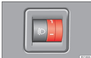
Fig. 150 Planche de bord : dispositif de réglage de la portée des phares.
