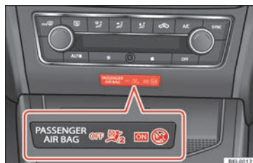
Fig. 57 Témoin de désactivation de l'airbag du passager.
