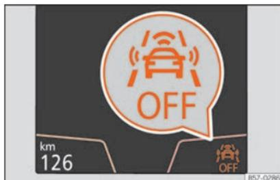
**Fig. 256** Sur l'écran du combiné d'instruments : indication de Front Assist désactivé.
