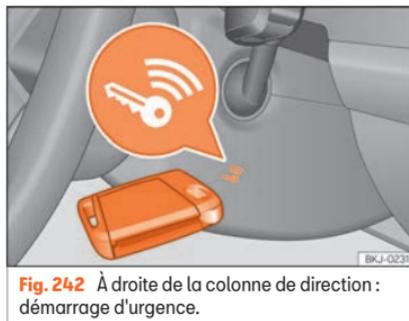
**Fig. 242** À droite de la colonne de direction : démarrage d'urgence.
