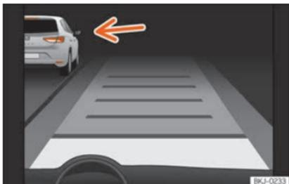
**Fig. 263** Sur l'écran du combiné d'instruments : ACC activé, véhicule circulant à gauche détecté
