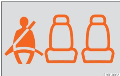
**Fig. 92** Combiné d'instruments : indication de place arrière droite occupée et de ceinture correspondante bouclée.
