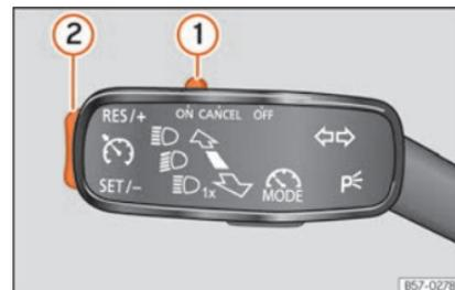
**Fig. 53** À gauche de la colonne de direction : contacteur et commandes d'utilisation du GRA.
