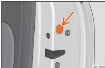
**Fig. 7** Verrouillage d'urgence de la porte.
