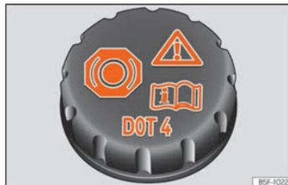
**Fig. 65** Compartiment-moteur : bouchon du réservoir du liquide de frein.
