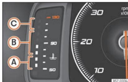
Fig. 131 Tableau de bord numérique : indicateur de température du liquide de refroidissement du moteur.
