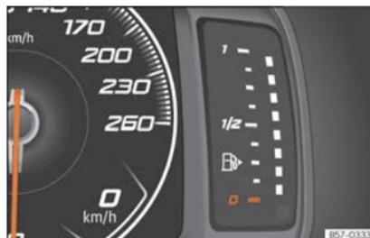
**Fig. 129** Tableau de bord numérique : indicateur du niveau de carburant.
