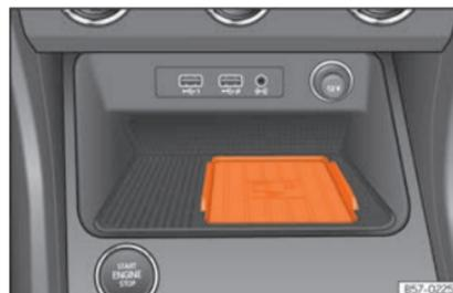
**Fig. 239** Dans la console centrale : logement pour la connexion du téléphone mobile.
