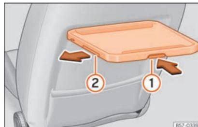
**Fig. 165** Siège avant gauche : tablette escamotable avec porte-gobelets.
