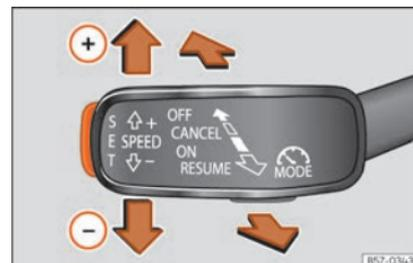
**Fig. 54** À gauche de la colonne de direction : troisième levier de commande du GRA.
