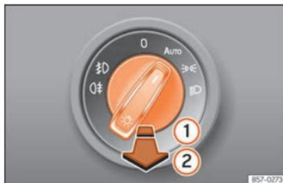
**Fig.152** Planche de bord : commande des feux.
