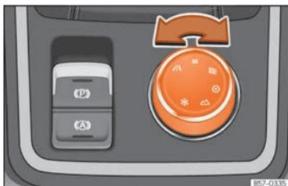
**Fig. 278** Console centrale : Commande rotative (Driving Experience button) sur le modèle Cupra.
