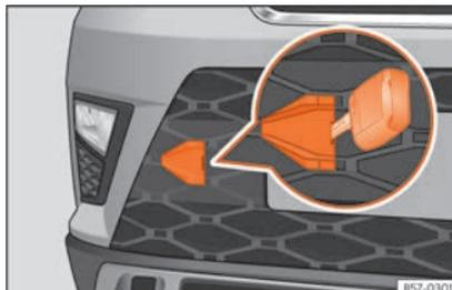
**Fig. 101** Du côté droit du pare-chocs avant : retirer le cache.
