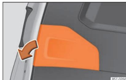
**Fig. 116** Hayon arrière ouvert : retirer le cache.
