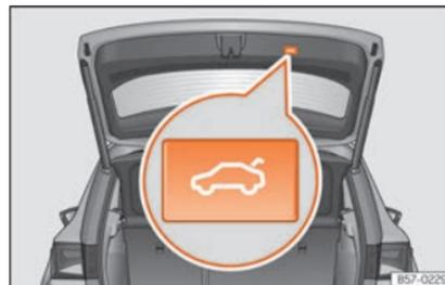
**Fig. 9** Hayon : touche de fermeture du hayon
