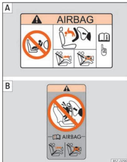
**Fig. 36** Autocollant de l'airbag - version 1 : sur le pare-soleil côté passager **A** et sur le cadre arrière de la porte du passager **B**.
