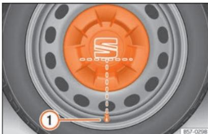
**Fig. 74** Placement correct de l'enjoliveur central de roue pour jantes en acier.
