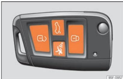
**Fig. 4** Clé à radiocommande : touches.
