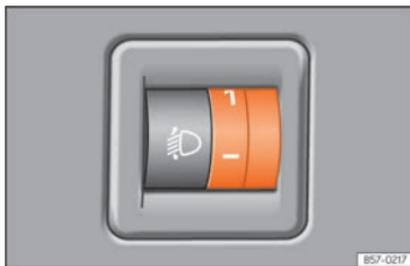
**Fig. 154** Côté volant : dispositif de réglage de la portée des phares.
