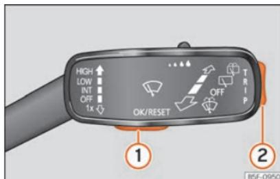
Fig. 132 Levier d'essuie-glace : touches de contrôle.
