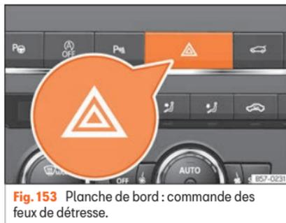
Fig. 153 Planche de bord : commande des feux de détresse.
