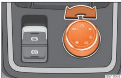
**Fig. 277** Console centrale : Commande rotative (Driving Experience button).
