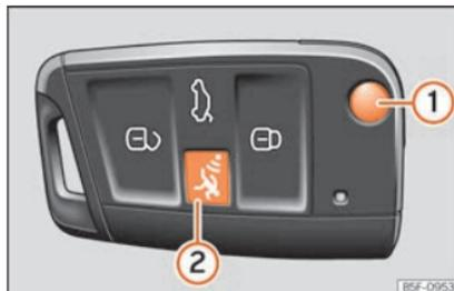
Fig. 137 Clé du véhicule avec bouton d'alarme.
