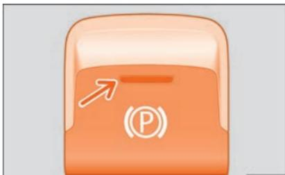
**Fig. 243** Sur la partie inférieure de la console centrale : touche du frein de stationnement électronique.
