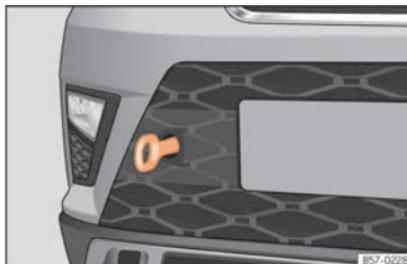
**Fig. 102** Du côté droit du pare-chocs avant : œillet de remorquage vissé
