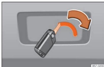
**Fig. 11** Coffre à bagages, côté droit : déverrouillage d'urgence.
