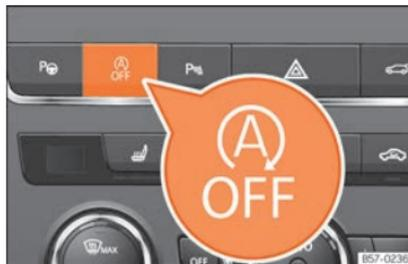
**Fig. 248** Console centrale : touche du système Start-Stop.
