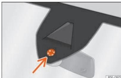
**Fig. 186** Capteur d'humidité et de température du pare-brise.
