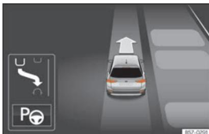
**Fig. 282** Sur l'écran du combiné d'instruments : affichage du système de stationnement assisté avec affichage réduit.
