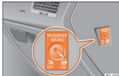
**Fig. 28** Commande de l'airbag frontal du passager.
