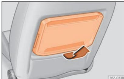
**Fig. 164** Siège avant gauche : tablette escamotable.
