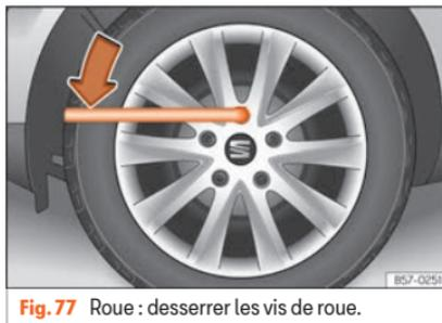
**Fig. 77** Roue : desserrer les vis de roue.
