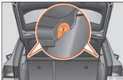
**Fig. 171** Dans le coffre à bagages : dépose et repose de la plage arrière.
