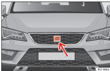
Fig. 193 Sur la face du véhicule derrière l'emblème SEAT : capteur radar.
