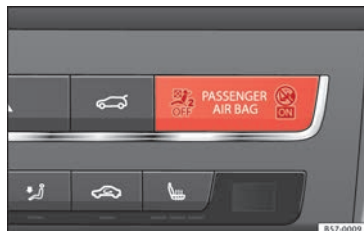
Fig. 93 Témoin de contrôle sur la planche de bord indiquant la désactivation de l'airbag frontal du passager avant.
