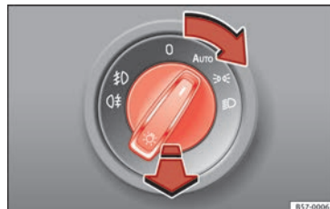
Fig. 35 Planche de bord : commande des feux.
