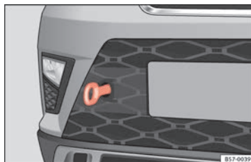
Fig. 75 Pare-chocs avant droit : øillet de remorquage vissé
