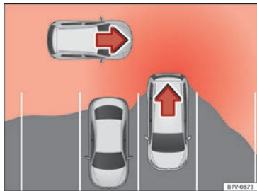
Fig. 206 Représentation schématique de l'assistant de sortie de stationnement : zone surveillée autour du véhicule sortant de stationnement.
