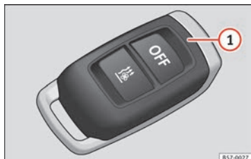
Fig. 168 Chauffage stationnaire : radiocommande.
