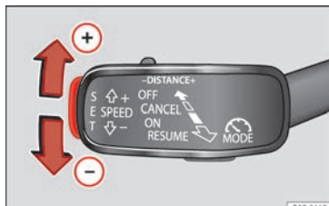
Fig. 187 À gauche de la colonne de direction : troisième levier pour utiliser le régulateur de vitesse adaptatif.
