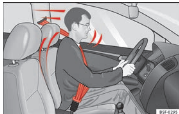
Fig. 88 Les conducteurs qui ont correctement bouclé leur ceinture de sécurité ne seront pas projetés en cas de freinage soudain.
