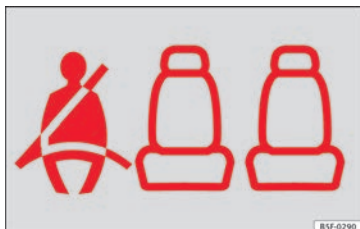
Fig. 87 Combiné d'instruments : indication de place arrière droite occupée et de ceinture correspondante bouclée.
