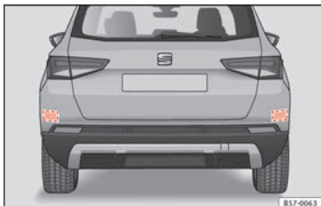
Fig. 203 Vue arrière du véhicule : zones des capteurs radars.
