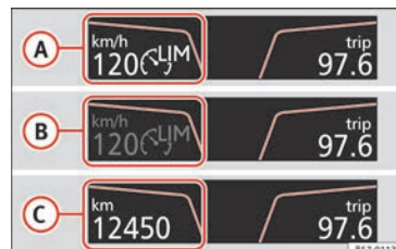
Fig. 179 Sur l'écran du combiné d'instruments : indications de l'état du limiteur de vitesse.
