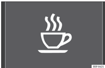
Fig. 210 Sur l'écran du combiné d'instruments : symbole de détection de la fatigue.
