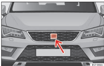
Fig. 185 Sur la face du véhicule derrière l'embblème SEAT : capteur radar.
