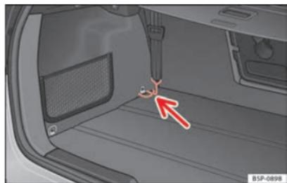
Fig. 122 Œillets d'arrimage permettant de tendre le filet de séparation.
