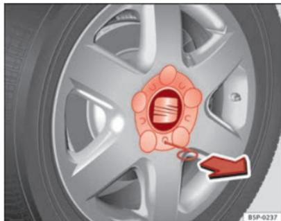
Fig. 171 Changement de roue : retirer l'enjoliveur de roue central.
