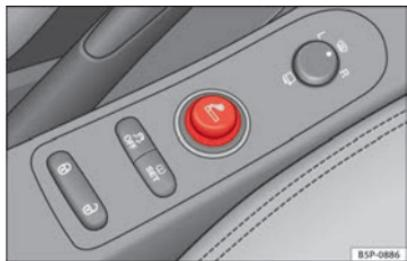
Fig. 110 Allume-cigare branché dans la prise de courant de la console centrale avant.
