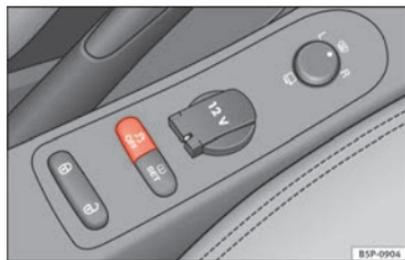
Fig. 134 Détail de la console centrale : touche ESC.
