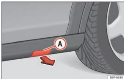
Fig. 176 Talonnette en plastique équipée d'une protection pour les points d'ancrage du cric.
