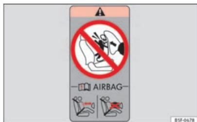
Fig. 17 Sur le cadre avant de la porte du passager : autocollant concernant l'airbag.
