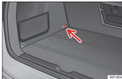
Fig. 32 Anneau de fixation Top Tether\*.
