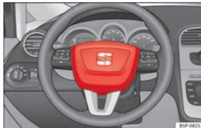
Fig. 18 Airbag du conducteur dans le volant.
