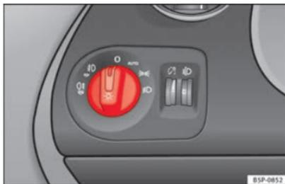
Fig. 68 Détail de la planche de bord : commande des feux, des phares antibrouillard et du feu arrière antibrouillard.
