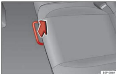
Fig. 90 Barre de déverrouillage de la banquette arrière.
