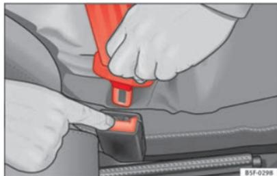
Fig. 12 Retrait du pêne du boîtier de verrouillage.
