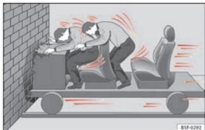
**Fig. 7 Le véhicule heurte le mur : les passagers n'ont pas bouclé leur ceinture.**
