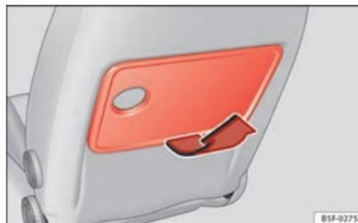
Fig. 97 Tablette escamotable du siège avant gauche.
