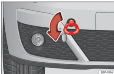
Fig. 210 Vissage de l'œillet de remorquage avant, côté droit.
