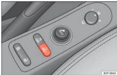
Fig. 48 Console centrale : touche du système de contrôle de la pression des pneus.
