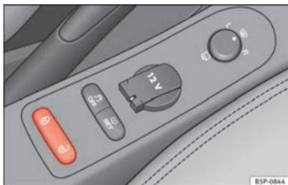
Fig. 55 Détail de la console centrale : Touche de verrouillage centralisé.
