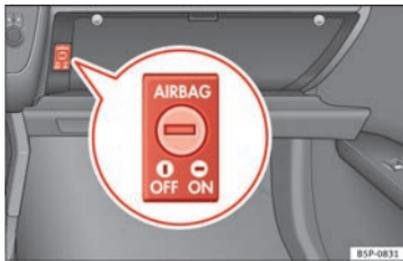
Fig. 22 Dans la boîte à gants se trouve commande à clé pour activer et désactiver les airbags du passager.
