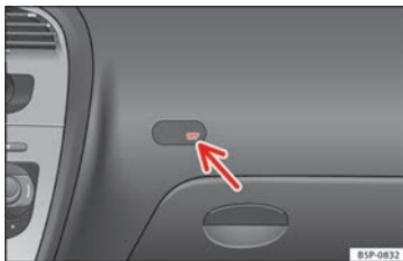
Fig. 23 Témoin de désactivation de l'airbag du passager.
