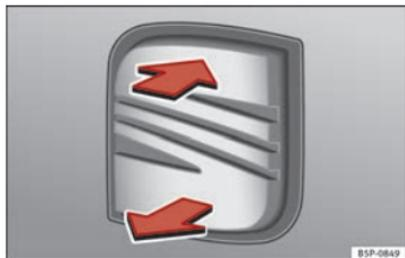
Fig. 62 Hayon : ouverture de l'extérieur.
