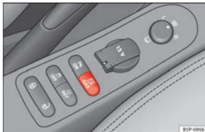
Fig. 136 Console centrale : contacteur de contrôle du système de gaz.
