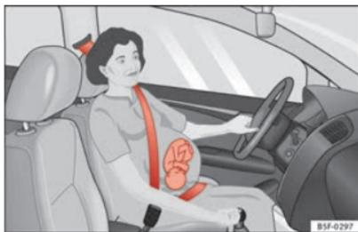
Fig. 14 Ajustement recommandé de la sangle de ceinture de sécurité pour les femmes enceintes.
