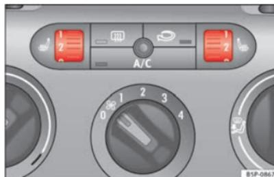
Fig. 88 Molettes des chauffages de sièges avant.
