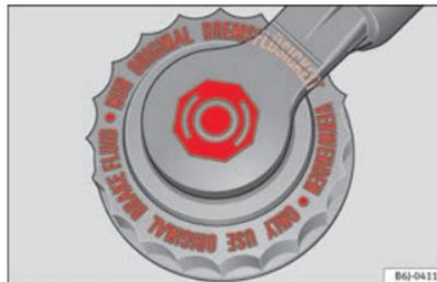
Fig. 167 Compartiment-moteur : bouchon du réservoir du liquide de frein.
