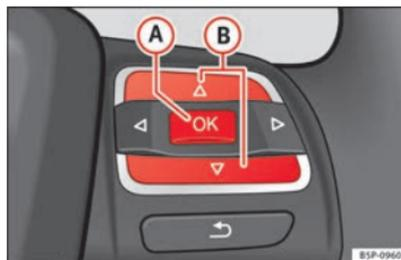
Fig. 45 Commandes au volant : touches de contrôle.
