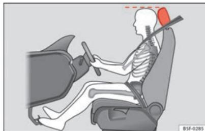
Fig. 2 Position correcte de l'appuie-tête du conducteur
