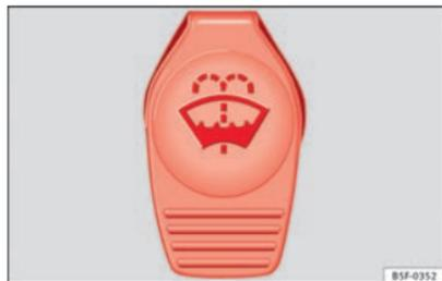
Fig. 162 Dans le compartiment-moteur : bouchon de réservoir de lave-glace
