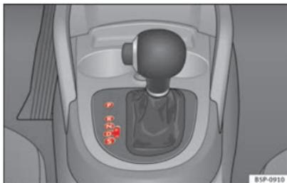
Fig. 140 Console centrale : levier sélecteur de la boîte automatique/boîte DSG.
