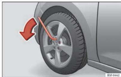
Fig. 173 Changement de roue : desserrer les boulons de roue.
