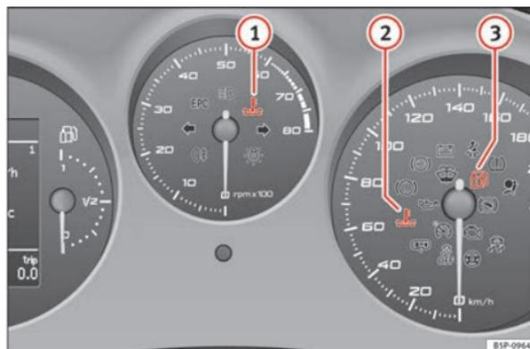
Fig. 47 Tableau de bord avec témoins d'alerte et de contrôle sur véhicules au GPL.
