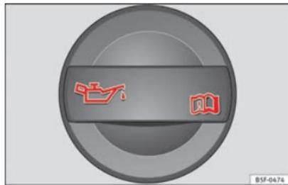
Fig. 160 Dans le compartiment-moteur : bouchon de l'orifice de remplissage d'huile moteur.
