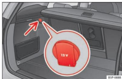
Fig. 112 Modèle Altea XL/Fretrack : prise de courant du coffre à bagages.
