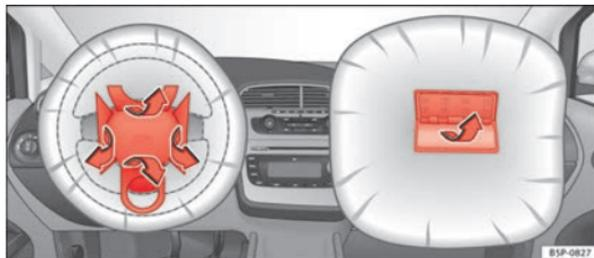
Fig. 21 Comportement des caches des modules d'airbags lors du déclenchement des airbags frontaux.
