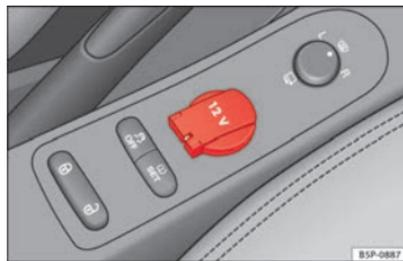
Fig. 111 Prise de courant de la console centrale avant.
