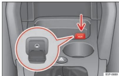
Fig. 113 Connecteur pour l'entrée auxiliaire audio.
