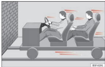
**Fig. 6 Véhicule sur le point de heurter un mur : les passagers n'ont pas bouclé leur ceinture.**
