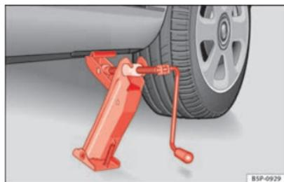
Fig. 175 Mise en place du cric.
