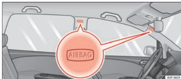
Fig. 26 Emplacement de montage des airbags rideaux du côté gauche du véhicule.
