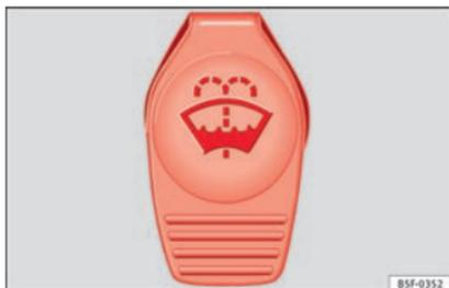
**Fig. 248** Dans le compartiment moteur : bouchon du réservoir du lave-glace.
