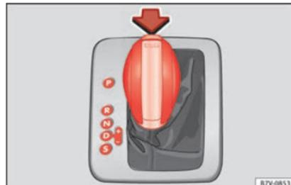
Fig. 48 Boîte automatique : positions du levier sélecteur.
