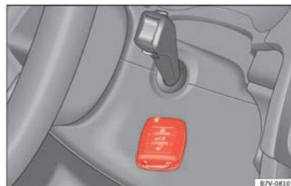
Fig. 199 Démarrage d'urgence sur les véhicules équipés de Keyless Access.
