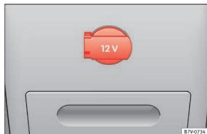
Fig. 192 Partie arrière de la console centrale : prise de courant de 12 volts
