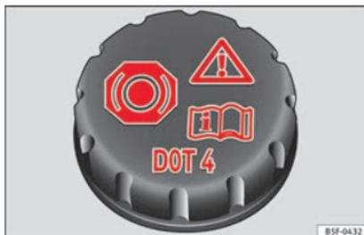
Fig. 247 Dans le compartiment moteur : bouchon du réservoir du liquide de frein.
