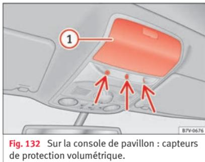
**Fig. 132** Sur la console de pavillon : capteurs de protection volumétrique.
