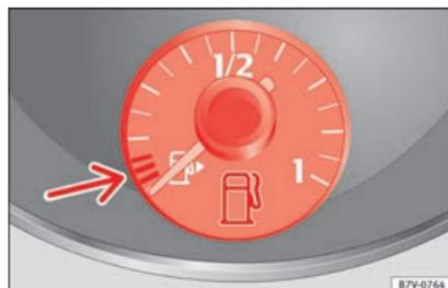
Fig. 235 Sur le tableau de bord : indicateur de niveau de carburant pour essence et diesel.
