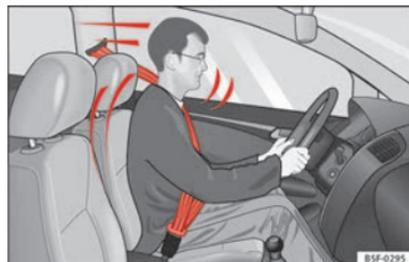
**Fig. 83** Les conducteurs qui ont correctement bouclé leur ceinture de sécurité ne seront pas projetés en cas de coups de frein soudains.
