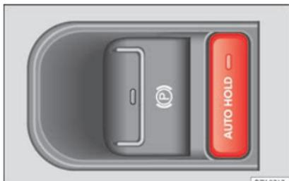
**Fig. 205** Détail de la console centrale : touche de l'Auto Hold
