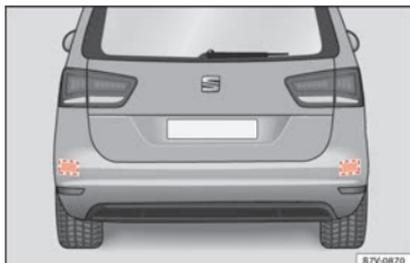
**Fig. 222** Vue arrière du véhicule : zones des capteurs radars.
