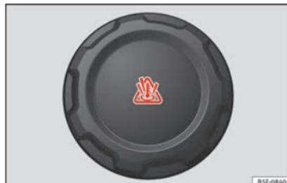
**Fig. 246** Dans le compartiment moteur : bouchon du vase d'expansion du liquide de refroidissement.
