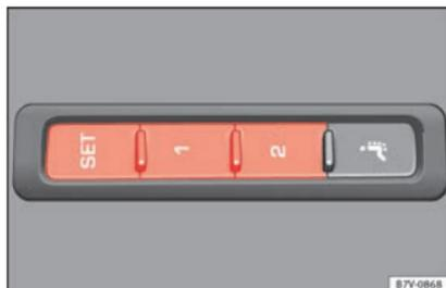
**Fig. 156** Touches de mise en mémoire sur la partie extérieure du siège du conducteur.
