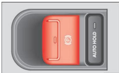
Fig. 200 Détail de la console centrale : contacteur du frein de stationnement électronique.
