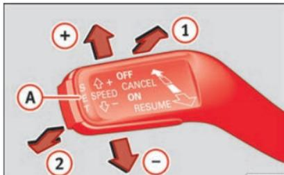
**Fig. 46** À gauche de la colonne de direction : contacteur et commandes d'utilisation du GRA.
