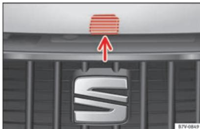
**Fig. 240** Levier de déverrouillage pour l'ouverture du capot moteur au niveau de la grille du radiateur.
