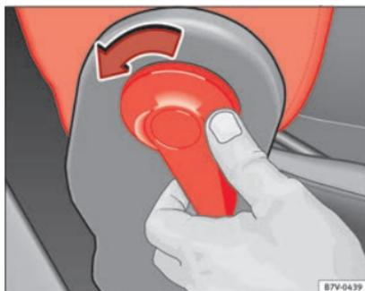
**Fig. 159** Débloquer le dossier rabattable du siège du passager avant.
