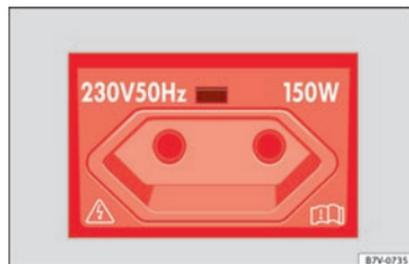
Fig. 193 Détail de la console centrale arrière : prise de courant européenne de 230 volts.
