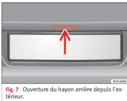
Fig. 7 Ouverture du hayon arrière depuis l'extérieur.
