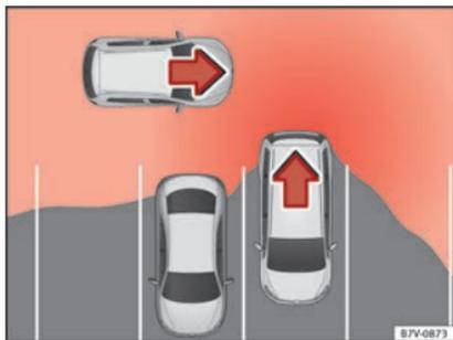
**Fig. 225** Représentation schématique de l'assistant de sortie de stationnement : zone surveillée autour du véhicule sortant de stationnement.
