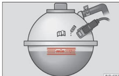
**Fig. 245** Dans le compartiment moteur : repère sur le vase d'expansion du liquide de refroidissement.
