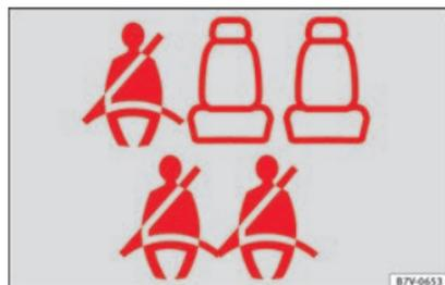
Fig. 82 Exemple d'indication de l'état de la ceinture pour les places arrière (dans le cas présent, véhicule à 7 places) sur le tableau de bord. en haut, deuxième rangée ; en bas, troisième rangée de sièges.
