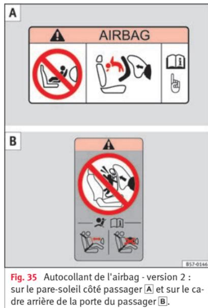
Fig. 35 Autocollant de l'airbag - version 2 : sur le pare-soleil côté passager [A] et sur le cadre arrière de la porte du passager [B].
