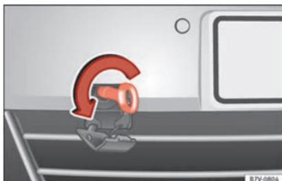
**Fig. 71** Sur la partie droite du pare-chocs avant : visser l'œillet de remorquage.
