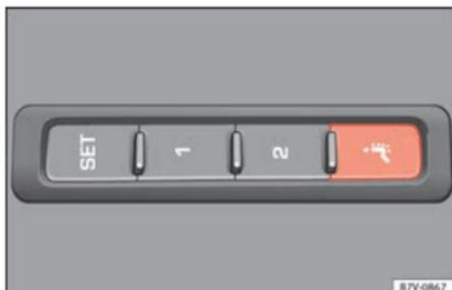
**Fig. 155** Sur le côté du siège avant : touche de fonction du massage lombaire.
