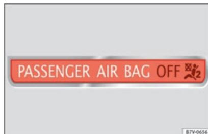
Fig. 90 Témoin de contrôle sur la planche de bord indiquant la désactivation de l'airbag frontal du passager avant.
