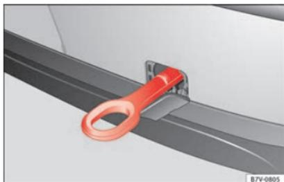
**Fig. 103** Sur le pare-chocs arrière, côté droit : œillet de remorquage vissé.
