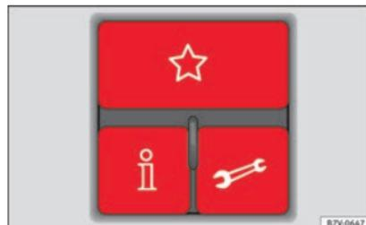
**Fig. 122** Plafonnier de trois touches dans le ciel de pavillon : éléments de commande du système de gestion du téléphone
