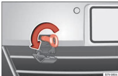
Fig. 102 Sur la partie droite du pare-chocs avant : visser l'œillet de remorquage.
