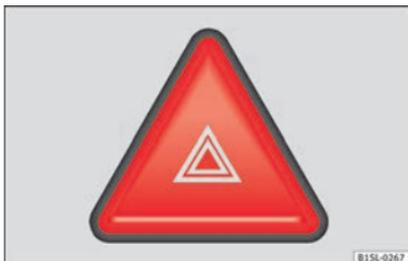
Fig. 42 Planche de bord : commande des feux de détresse.
