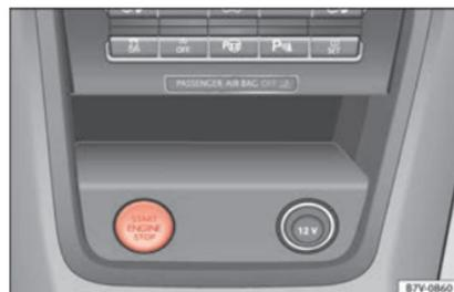
Fig. 198 Dans la console centrale : bouton de démarrage du système de fermeture et démarrage sans clé Keyless Access. Sur les véhicules avec le volant à droite, le réglage est symétrique.
