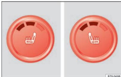
**Fig. 153** Détail de la console centrale : commandes pour le chauffage des sièges avant, dans notre cas avec le second niveau de température activé.
