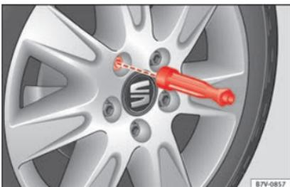
Fig. 70 Changement de roue : desserrer les boulons de la roue avec le manche du tournevis.
