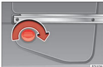
**Fig. 237** Dans la partie arrière gauche du coffre : réservoir d'AdBlue, derrière un couvercle.
