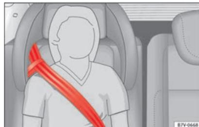
Fig. 95 Siège intégré pour enfants : parcours de la sangle de la ceinture avec poignée de guidage.
