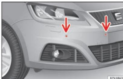
**Fig. 208** Capteurs du système d'aide au stationnement dans le pare-chocs avant.
