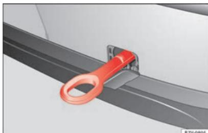
**Fig. 72** Sur le pare-chocs arrière, côté droit : œillet de remorquage vissé.
