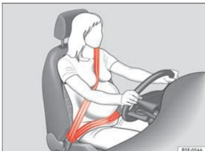
**Fig. 87** Ajustement recommandé de la sangle de ceinture de sécurité pour les femmes enceintes.
