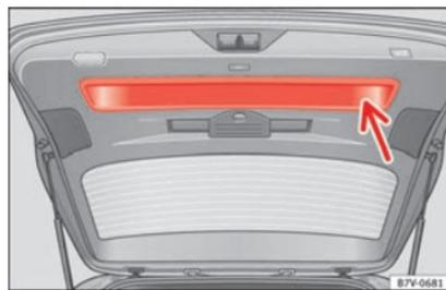
Fig. 136 Hayon arrière ouvert : cavité pour tirer.
