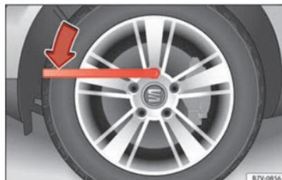
Fig. 66 Changement de roue : desserrez les boulons de la roue.
