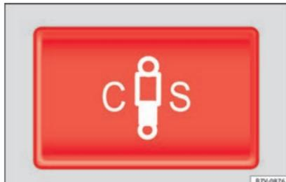
**Fig. 228** Dans la console centrale : touche de réglage de la suspension adaptative.
