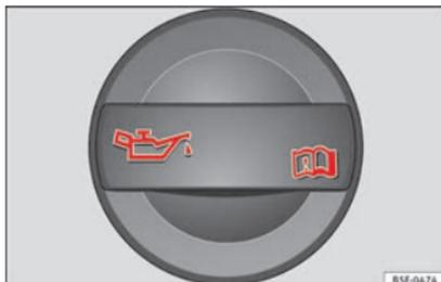
Fig. 243 Dans le compartiment moteur : bouchon de l'orifice de remplissage de l'huile moteur.
