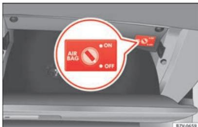
**Fig. 91** Dans la boîte à gants, côté passager : commande à clé pour activer et désactiver l'airbag frontal côté passager.
