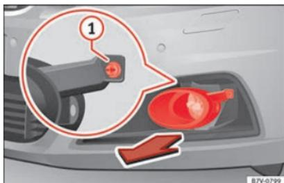
**Fig. 108** Sur la partie droite du pare-chocs avant : démontage des phares.
