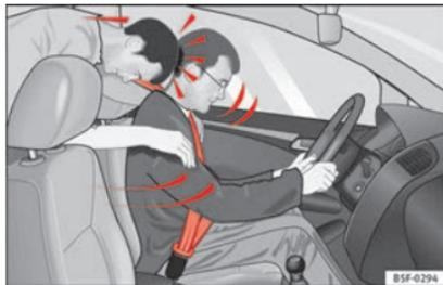
**Fig. 85** Le passager arrière n'ayant pas bouclé sa ceinture est projeté en avant et vient heurter le conducteur qui a bouclé sa ceinture.
