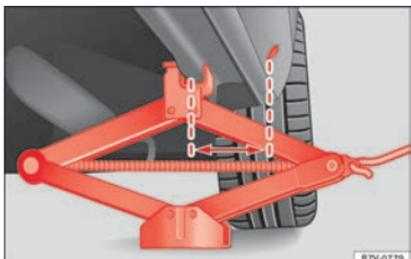
Fig. 69 Cric placé sur la partie arrière gauche du véhicule.
