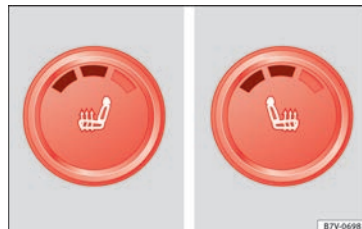
Fig. 154 Détail de la console centrale : commandes pour le chauffage des sièges avant, dans notre cas avec le second niveau de température activé.
