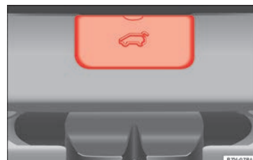
Fig. 8 Dans le coffre à bagages : démontage du cache du hayon arrière.
