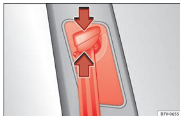
Fig. 90 Près des sièges avant : dispositif de réglage en hauteur de la ceinture.
