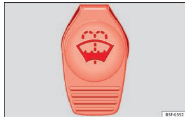
Fig. 58 Dans le compartiment moteur : bouchon du réservoir de liquide lave-glace.
