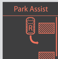
Fig. 213 Place détectée : engagez la marche arrière pour vous garer (en créneau ou en bataille).
