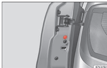
Fig. 4 Sur la face avant de la porte coulissante : verrouillage d'urgence, caché par un joint en caoutchouc.
