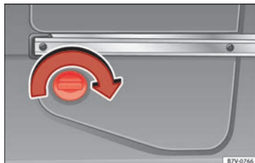
Fig. 236 Dans la partie arrière gauche du coffre : réservoir d'AdBlue, derrière un couvercle.
