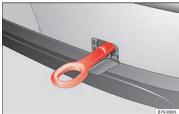
Fig. 104 Sur le pare-chocs arrière, côté droit : œillet de remorquage vissé.
