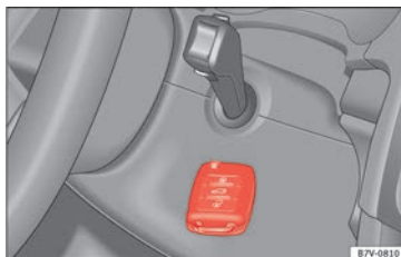
Fig. 200 Démarrage d'urgence sur les véhicules équipés de Keyless Access.
