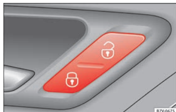
Fig. 130 Sur la porte du conducteur : touche de verrouillage centralisé.
