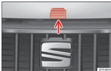
Fig. 239 Levier de déverrouillage pour l'ouverture du capot moteur au niveau de la grille du radiateur.
