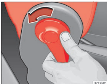
Fig. 160 Débloquer le dossier rabattable du siège du passager avant.
