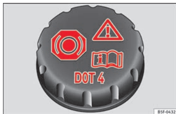
Fig. 246 Dans le compartiment moteur : bouchon du réservoir du liquide de frein.
