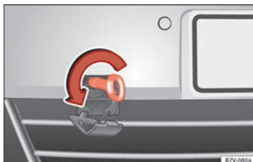
Fig. 103 Sur la partie droite du pare-chocs avant : visser l'œillet de remorquage.
