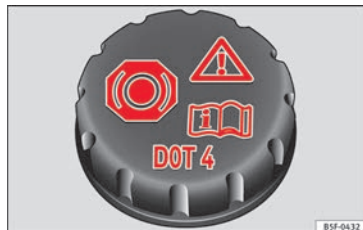
Fig. 57 Compartiment-moteur : bouchon du réservoir du liquide de frein.
