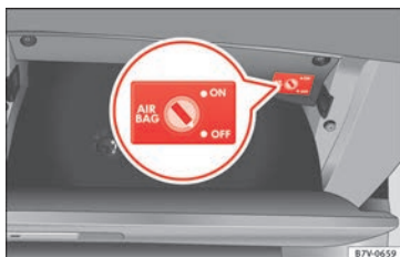
Fig. 27 Dans la boîte à gants, côté passager : commande à clé pour activer et désactiver l'airbag frontal côté passager.
