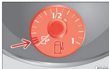
Fig. 234 Sur le tableau de bord : indicateur de niveau de carburant pour essence et diesel.
