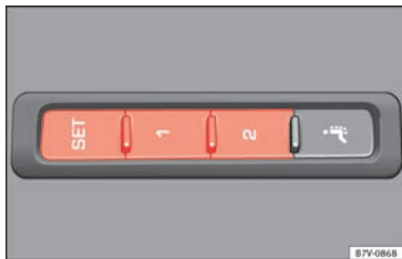
Fig. 157 Touches de mise en mémoire sur la partie extérieure du siège du conducteur.
