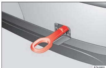
Fig. 73 Sur le pare-chocs arrière, côté droit : œillet de remorquage vissé.
