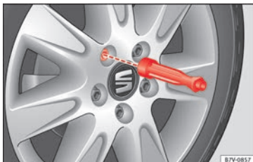
Fig. 71 Changement de roue : desserrer les boulons de la roue avec le manche du tournevis.
