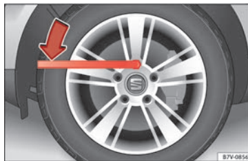
Fig. 67 Changement de roue : desserrez les boulons de la roue.
