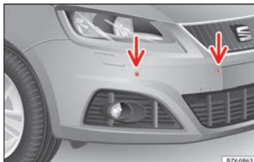
Fig. 209 Capteurs du système d'aide au stationnement dans le pare-chocs avant.
