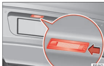
Fig. 115 Sur le pare-chocs arrière : éclairage de la plaque d'immatriculation.
