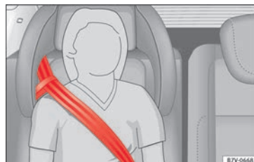
Fig. 96 Siège intégré pour enfants : parcours de la sangle de la ceinture avec poignée de guidage.
