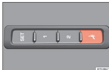
Fig. 156 Sur le côté du siège avant : touche de fonction du massage lombaire.
