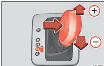
Fig. 203 Levier sélecteur sur la position Tiptronic (véhicules avec volant à gauche). Les véhicules avec le volant à droite sont disposés de manière symétrique.
