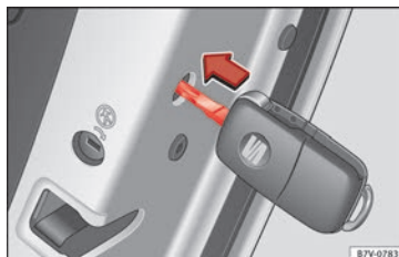
Fig. 5 Verrouillage de secours du véhicule avec la clé de celui-ci.
