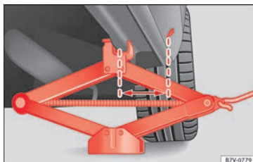
Fig. 70 Cric placé sur la partie arrière gauche du véhicule.
