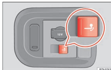
Fig. 229 Côté droit du coffre à bagages : touche permettant de basculer la boule d'attelage électriquement.
