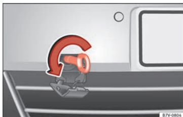
Fig. 72 Sur la partie droite du pare-chocs avant : visser l'œillet de remorquage.
