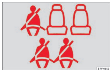
Fig. 83 Exemple d'indication de l'état de la ceinture pour les places arrière (dans le cas présent, véhicule à 7 places) sur le tableau de bord. en haut, deuxième rangée ; en bas, troisième rangée de sièges.
