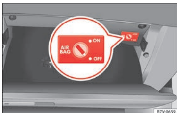
Fig. 92 Dans la boîte à gants, côté passager : commande à clé pour activer et désactiver l'airbag frontal côté passager.
