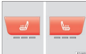
Fig. 155 Détail de la console centrale : commandes de chauffage des sièges avant sur les véhicules équipés de Climatronic.
