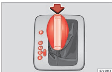
Fig. 202 levier sélecteur de la BV automatique avec touche de blocage (flèche).
