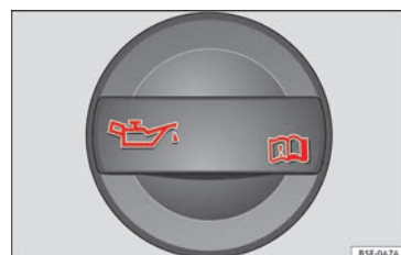
Fig. 55 Dans le compartiment-moteur : bouchon de l'orifice de remplissage d'huile moteur.
