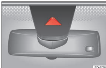
Fig. 219 Sur le pare-brise : fenêtre de la caméra de l'assistant de maintien de voie.
