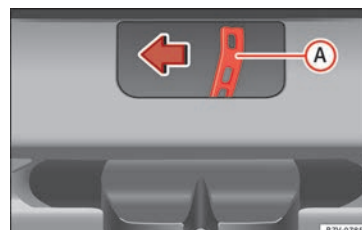
Fig. 9 Dans le coffre à bagages : déverrouillage d'urgence du hayon arrière.
