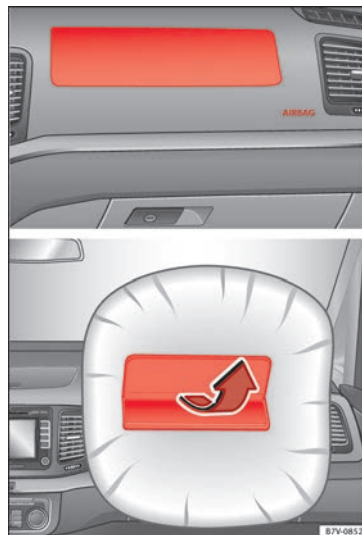
Fig. 26 Emplacement et champ d'action de l'airbag frontal du passager avant.
