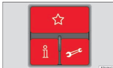
Fig. 123 Plafonnier de trois touches dans le ciel de pavillon : éléments de commande du système de gestion du téléphone
