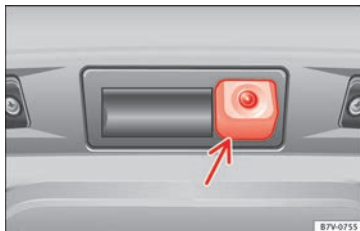
Fig. 214 Dans le hayon arrière : emplacement de la caméra de l'assistant de marche arrière.
