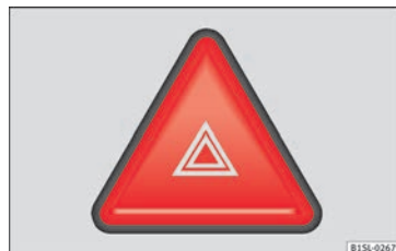
Fig. 140 Au centre de la planche de bord : touche des feux de détresse.
