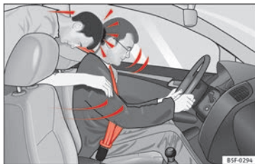
Fig. 86 Le passager arrière n'ayant pas bouclé sa ceinture est projeté en avant et vient heurter le conducteur qui a bouclé sa ceinture.
