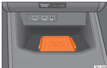
Fig. 67 Console centrale : Connectivity Box
