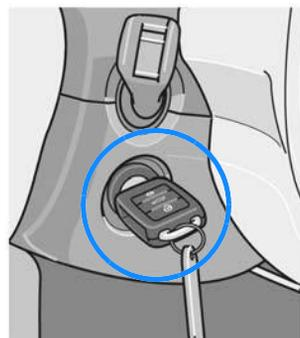
Tourner la clé de contact sur la « position ARRÊT » et la retirer.
