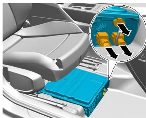
En cas d'accident avec déclenchement d'un sac gonflable (airbag), le système électrique 48 V du véhicule est automatiquement désactivé.
