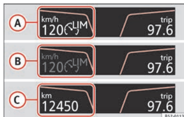
Fig. 154 Sur l'écran du combiné d'instruments : indications de l'état du limiteur de vitesse.
