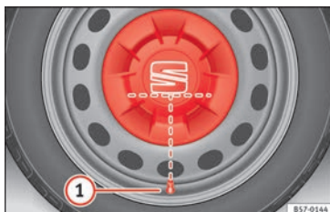
Fig. 63 Pose correcte de l'enjoliveur central de roue pour jantes en acier.
