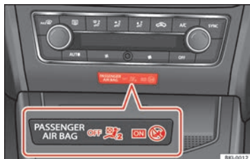
Fig. 89 Sur le tableau de bord, au centre : témoin de désactivation de l'airbag du passager avant.
