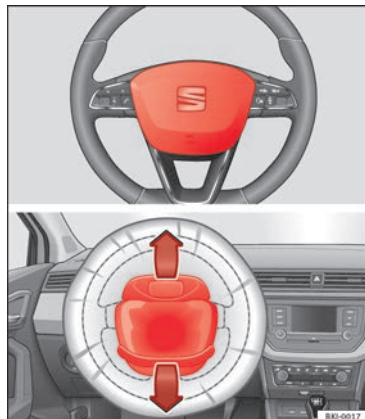
Fig. 17 Airbag du conducteur dans le volant.
