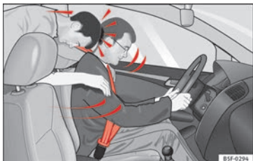
Fig. 85 L'occupant de la banquette arrière non attaché est projeté en avant et vient heurter le conducteur attaché.
