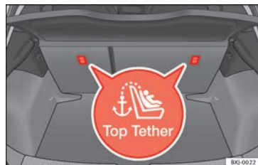
Fig. 27 Position des anneaux Top Tether sur la partie arrière de la banquette arrière.
