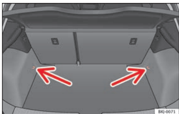
Fig. 142 Emplacements des œillets d'arrimage dans le coffre à bagages.
