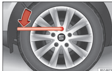
Fig. 66 Changement de roue : desserrer les vis de roue.
