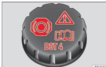
Fig. 56 Compartiment-moteur : bouchon du réservoir du liquide de frein.
