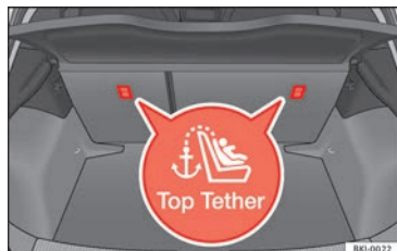
Fig. 29 Position des anneaux Top Tether sur la partie arrière de la banquette arrière.
