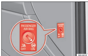
Fig. 88 Commande à clé permettant d'activer et désactiver les airbags du passager.
