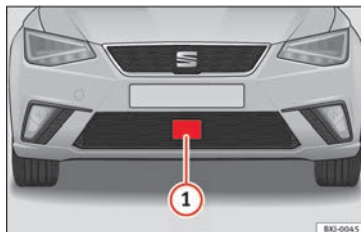
Fig. 164 Au niveau du pare-chocs avant : capteur radar.
