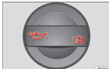
Fig. 54 Dans le compartiment-moteur : bouchon de l'orifice de remplissage d'huile moteur.
