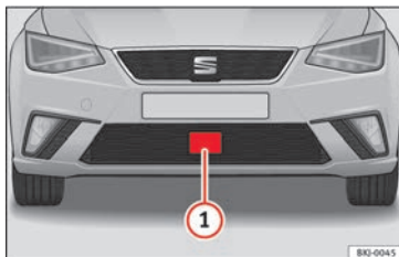
Fig. 158 Au niveau du pare-chocs avant : capteur radar.
