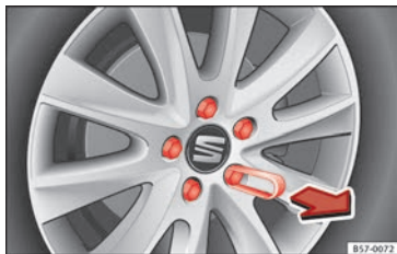
Fig. 65 Roue : boulons de roue avec capuchons.
