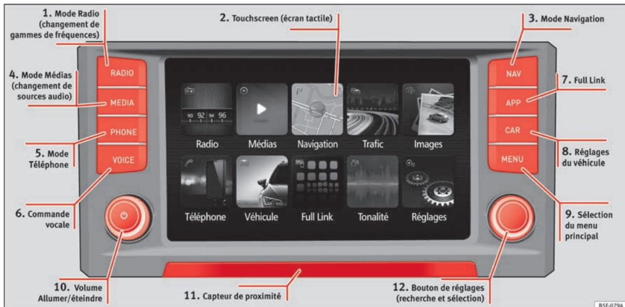
Fig. 2 Vue d'ensemble des éléments de commande
